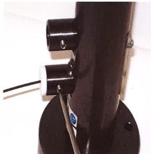
Die Verschlusskappen abziehen und die beiden anderen Enden in die seitlichen Buchsen der Auswerteeinheit BV7 stecken.
