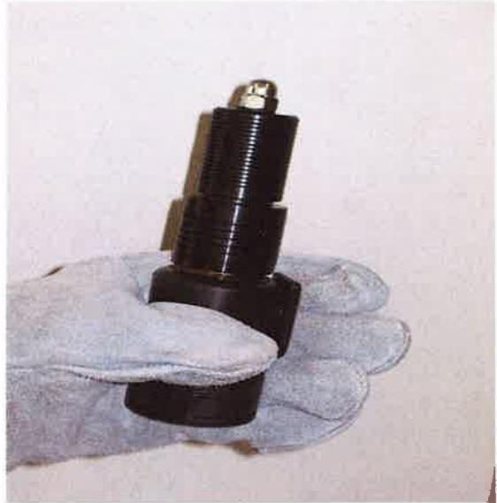
4. Arbeitshandschuhe anziehen, gesicherten Verschlusskopf spannen und aufsetzen. Beugen Sie sich nicht über den eingesetzten Schussapparat.
