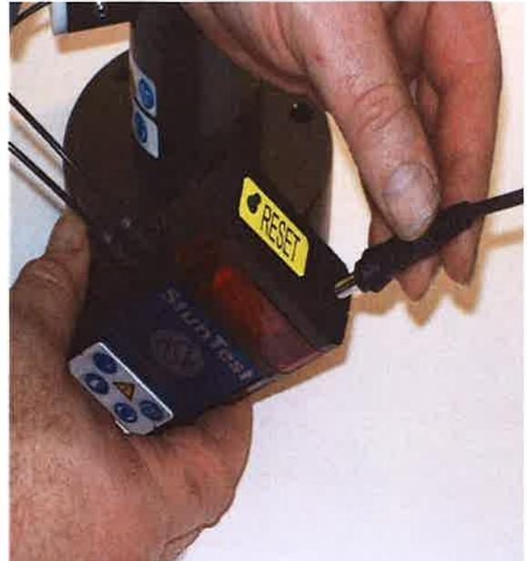
3. Netzteil BV8 anschließen.
